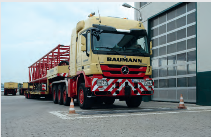
... rollt vorher aber noch über die im Boden fest eingebaute Reifenprüfanlage.
