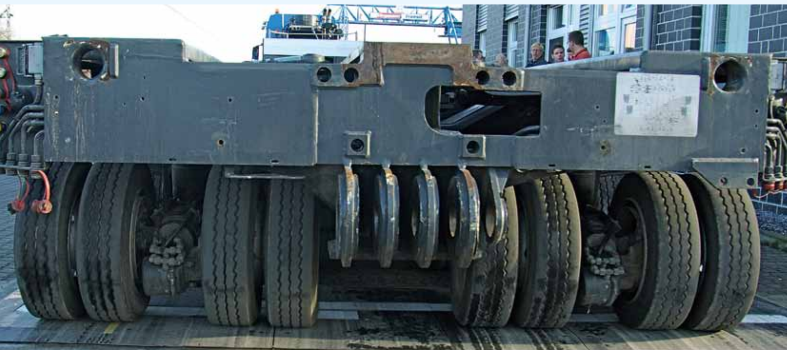
Die Sensorplatten erleichtern besonders die Kontrolle der innen liegenden Pneus.
